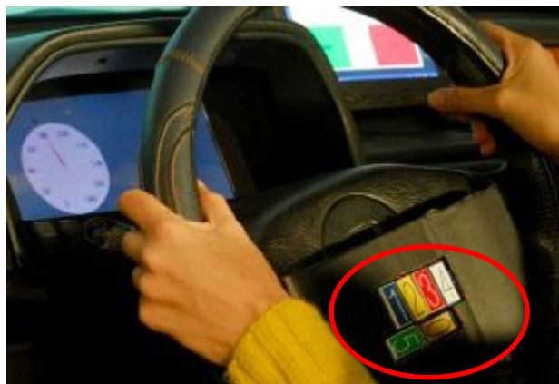
תרשים 12: מערכת ה-ICT מותקנת על הגה הסימולטור.
