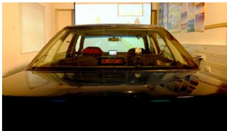
תרשים 4: מכונת הסימולטור וזווית הראיה של הנהג
